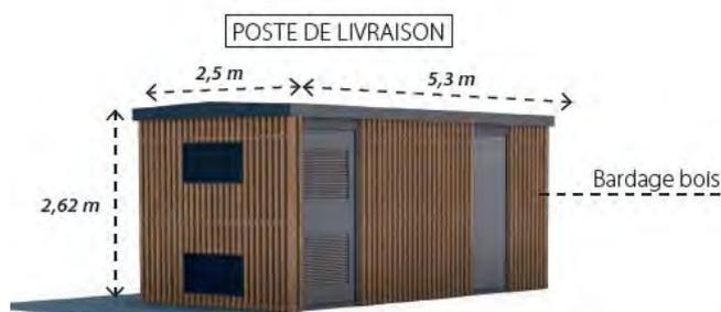
Figure 6. Schéma du local technique utilisé dans le cadre du projet (COMPOSITE)
