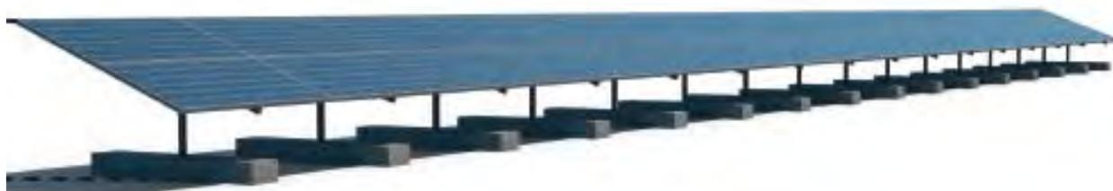
Figure 14. Schéma des modules et leurs structures porteuses (COMPOSITE)
