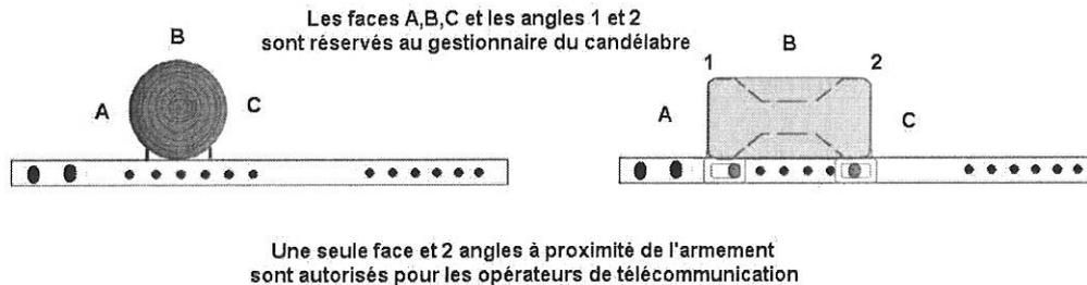
Figure 3 - Positionnement de la traverse télécom
