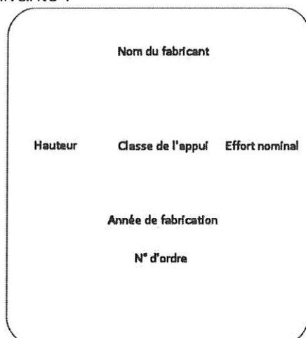
Figure 1 - Marquage sur poteau béton
